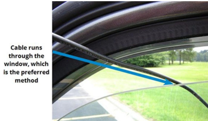
Figura 15 - Cable de antena a través de la ventana
