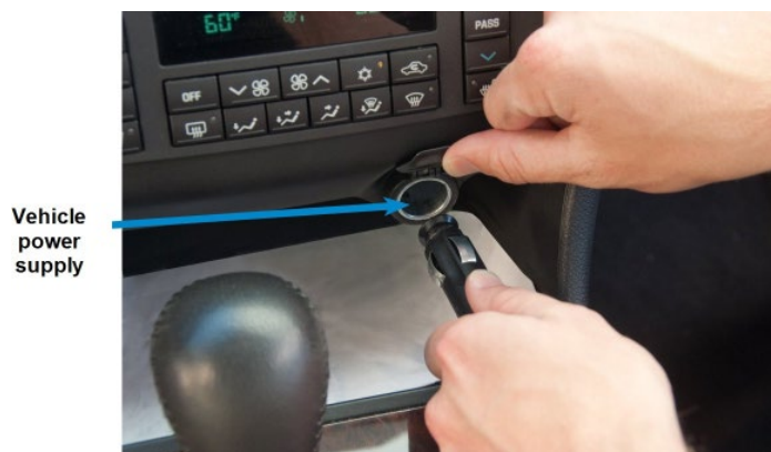
Figura 11 - Cable de alimentación insertado en el vehículo
