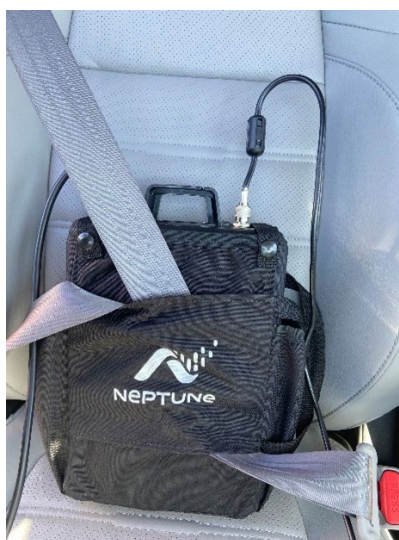
Figura 9 - Instalación del colector de datos portátil
