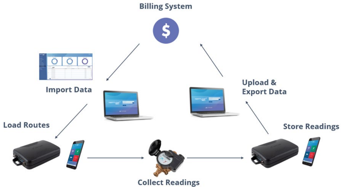
Figura 2 - Operaciones de lectura de medidores del colector de datos portátil
